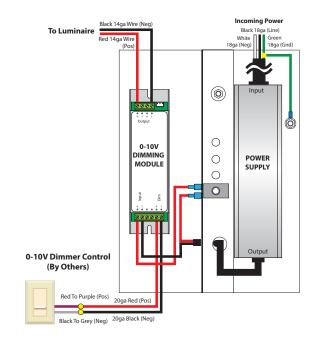
**ADNM-60-1-5-12-DOT** 120-277V AC / 12V DC, 60W /1 CIRCUIT X 5A **ADNM-90-1-4-24-DOT** 120-277V AC / 24V DC, 90W /1 CIRCUIT X 4A
